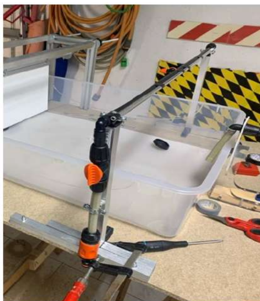
Figura 19. Costruzione dei micro-nebulizzatori per la simulazione delle piogge nella Streambox AR dell'Università di Macerata. Costruzione dell'autore.
