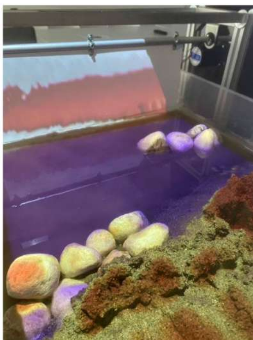
Figura 20. Particolare del simulatore di onde del mare nella Streambox AR dell'Università di Macerata, durante una lezione sull'erosione marittima all'Università di Macerata. Elaborazione dell'autore.
