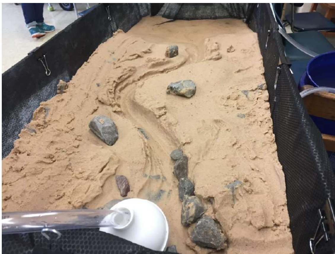
Figura 26. Esempio di Stream Table analogica. Fonte: University of Tennessee Knoxville.
