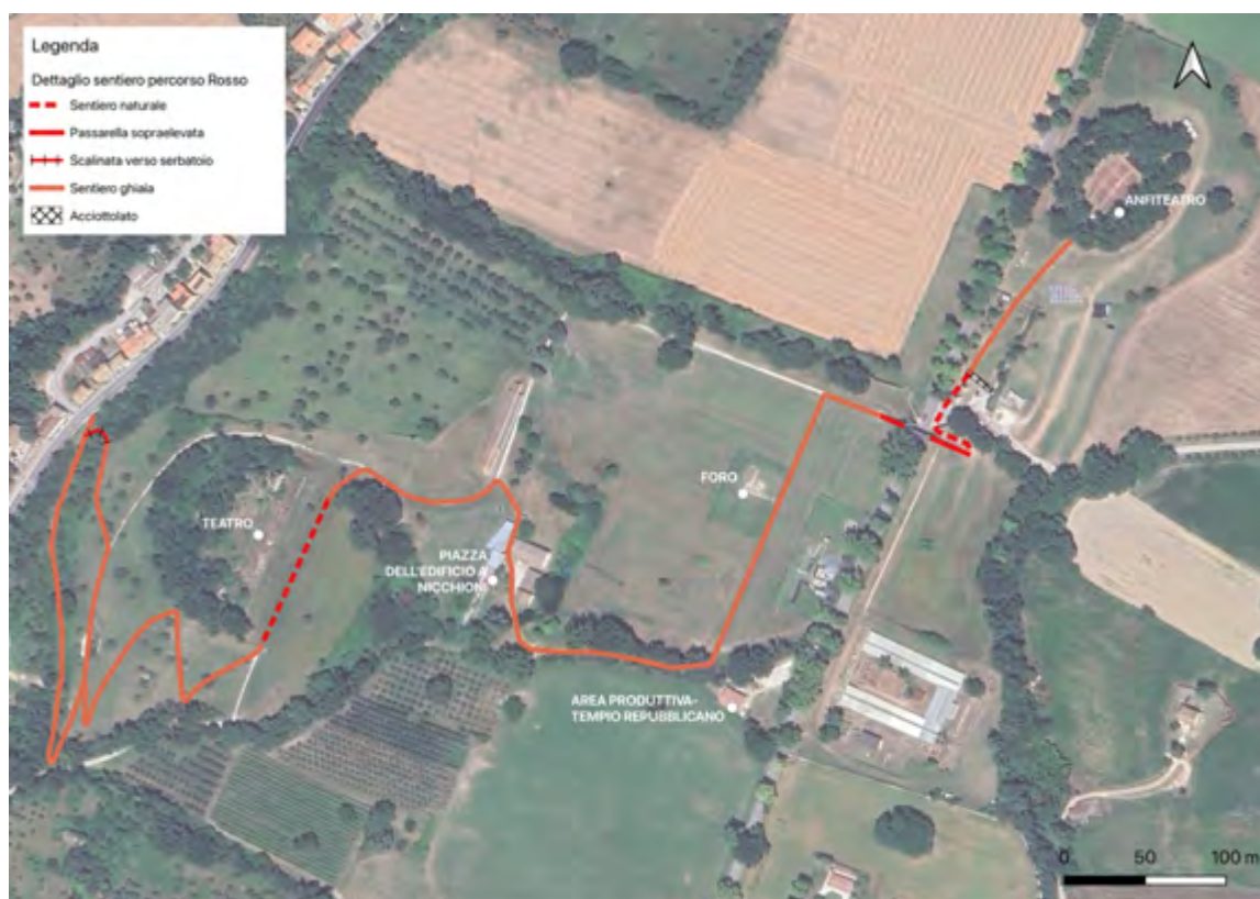
Figura 71 - Superfici di calpestio del percorso rosso: tratti in ghiaia fine, passerella sopraelevata e zone a fondo naturale. Fonte: elaborazione GIS dell'autore.
