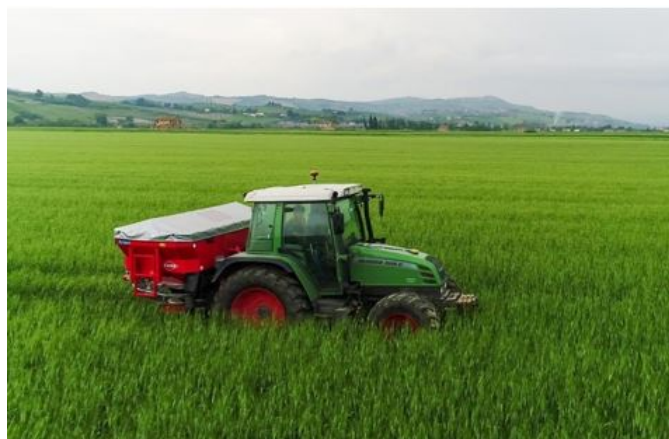
Figura 2 - Sistema di Guida Gnss e spandiconcime Vra
