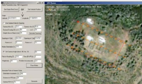
Figura 3 - Piano di volo con software proprietario AscTec.
