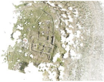
Figura 8 - Nuvola di punti prodotta con software open-source.
