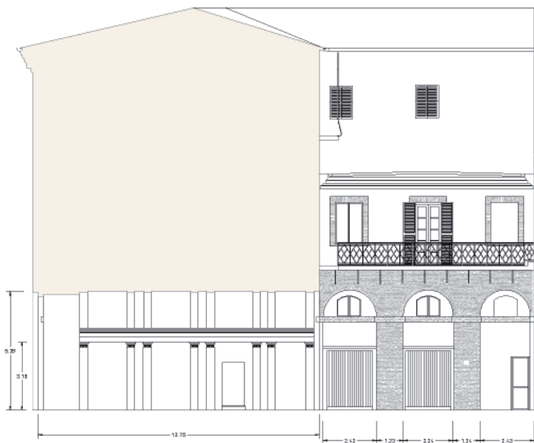
Fig. 14-15. Palazzo De Sanctis, sezioni longitudinali dell'androne e prospetti interni della corte. Rilievo (S. Bianucci S. Iacopini A. Mogetta M. Speranzini, 2013)
