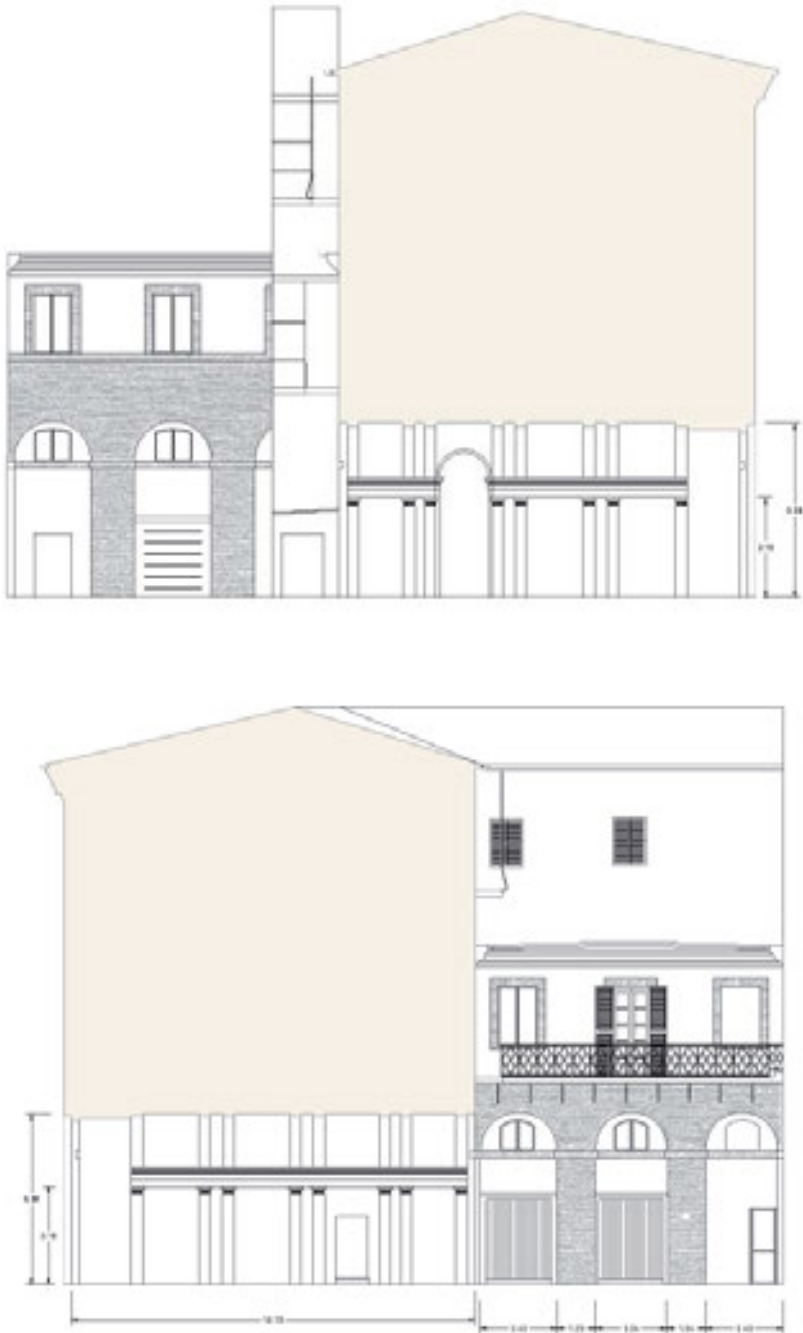
Fig. 14-15. Palazzo De Sanctis, sezioni longitudinali dell'androne e prospetti interni della corte. Rilievo (S. Bianucci S. Iacopini A. Mogetta M. Speranzini 2013)
