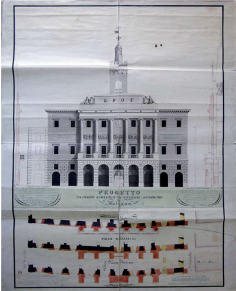
Fig. 3. Antonio Mollari, Progetto di nuova facciata di Palazzo Comunale di Foligno, unendo alla decorazione il rinforzo, e sostegno alla sopra posta torre danneggiata nel lato che guarda la piazza dai tremuoti , 1834, SASF, Archivio Moderno, b. 1035.
