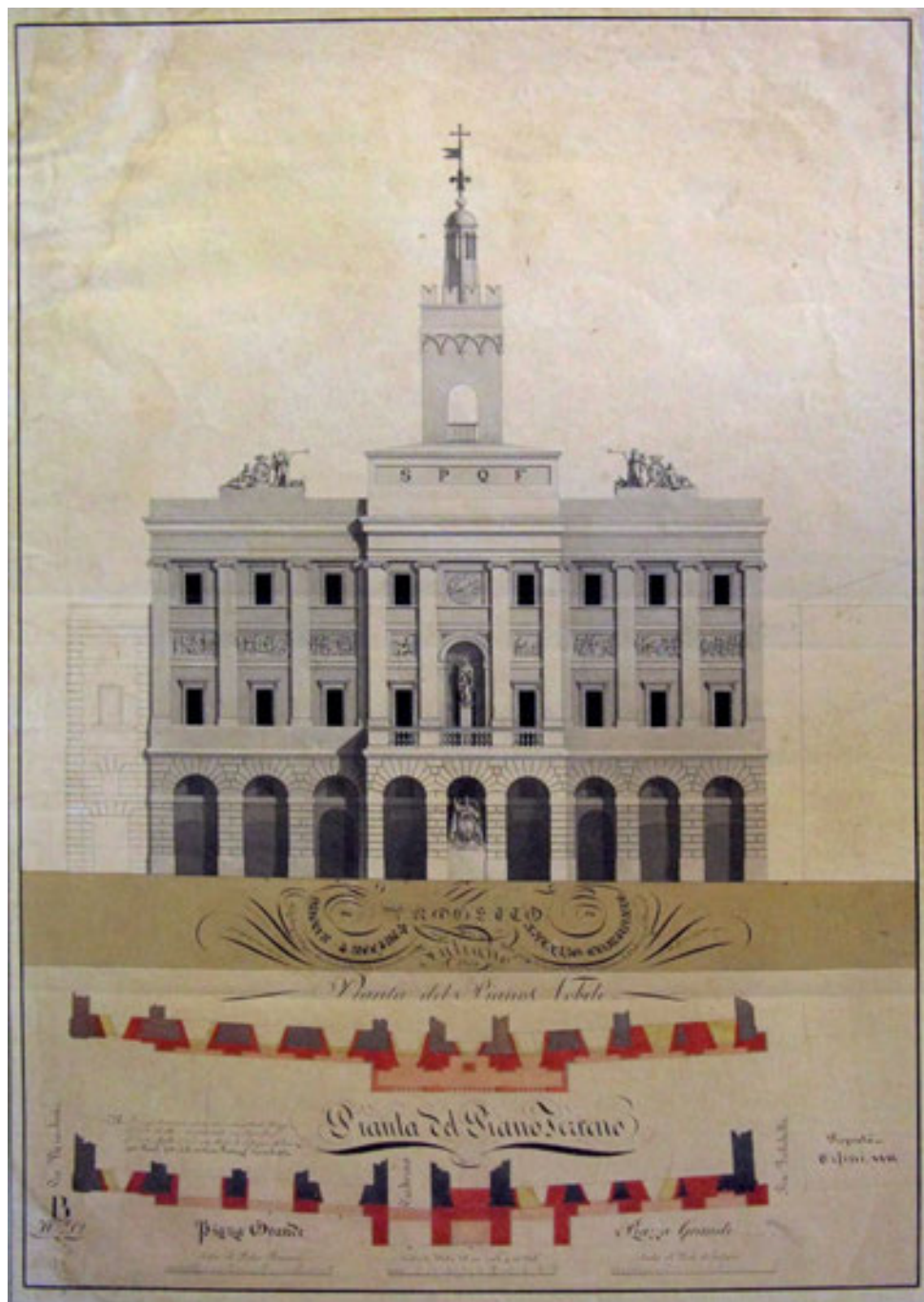
Fig. 6. Antonio Mollari (?), Progetto di Nuova Facciata al Palazzo Comunale di Foligno col rinforzo e sostegno alla sopraposta torre minacciate rovina per forti scosse di tremuoto, che la danneggiarono dal piede sino al 2° Piano del Pal.o , 1833, BCF, X, 15/3.
