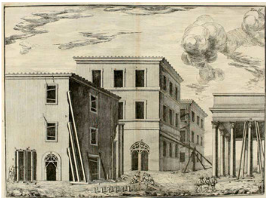
Fig. 17. Masi 1788, Puntellature e rifondazione di una colonna
