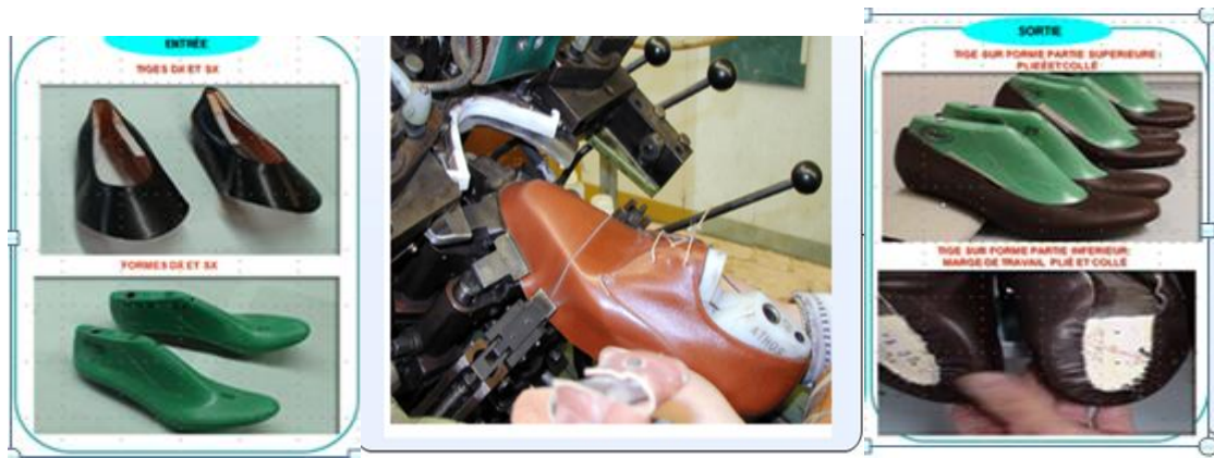
Fig. 3.5. Il montaggio della parte anteriore della tomaia su forma; semilavorati in ingresso e in uscita
