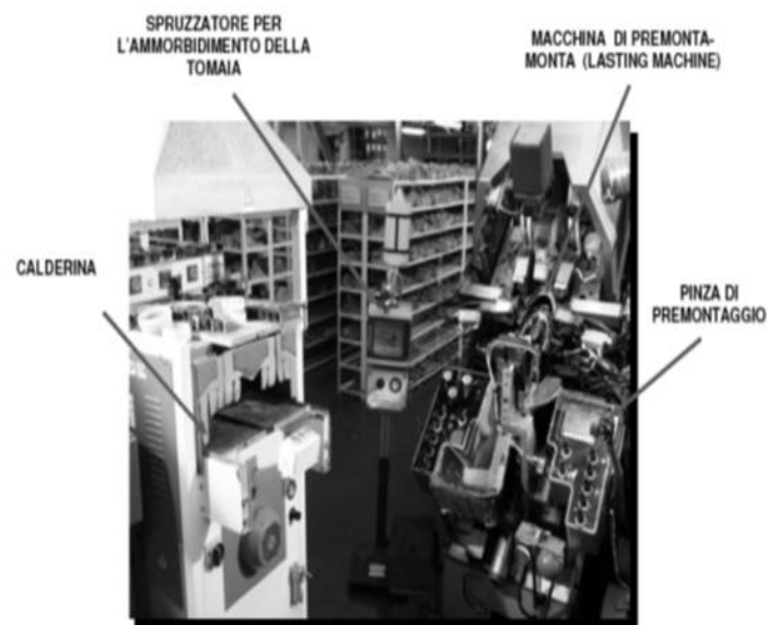
Fig. 3.4. Il posto di lavoro di premonta –monta.
