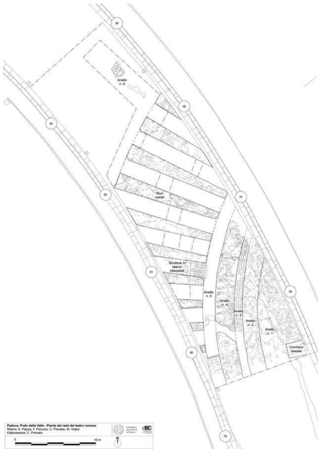
Fig. 10 Planimetria delle fondazioni della cavea del teatro individuate sul fondo del canale dell'isola Memmia, con distinzione delle diverse parti strutturali.
